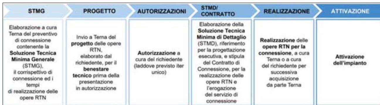
Fig. 14 – Fasi successive dell'iter di connessione di produzioni elettriche alla RTN
