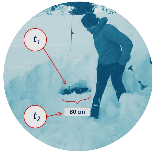
Figura 2: I parametri (istanti temporali) misurati: t_1 il raggiungimento della punta della sonda, e t_2 l'allargamento della buca tale da accogliere un simulacro fisico di dimensioni predefinite.
