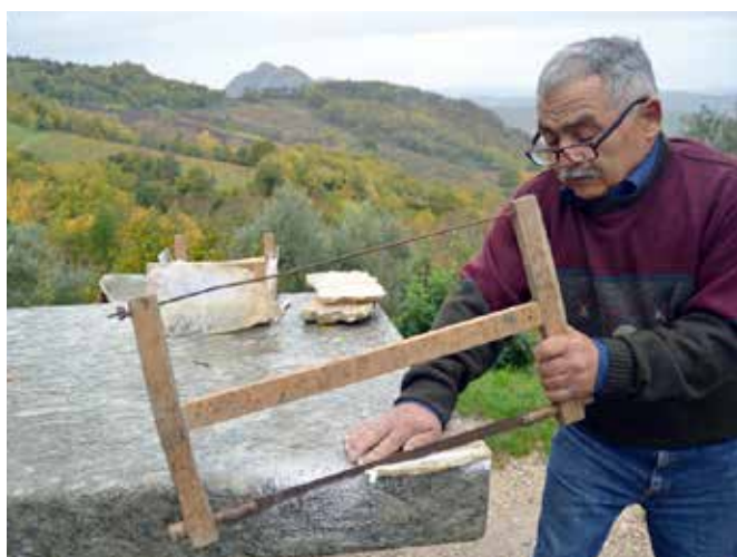
Fig. 16 Taglio di lastra di lapis con sega da legno (foto I. Fabbri)
