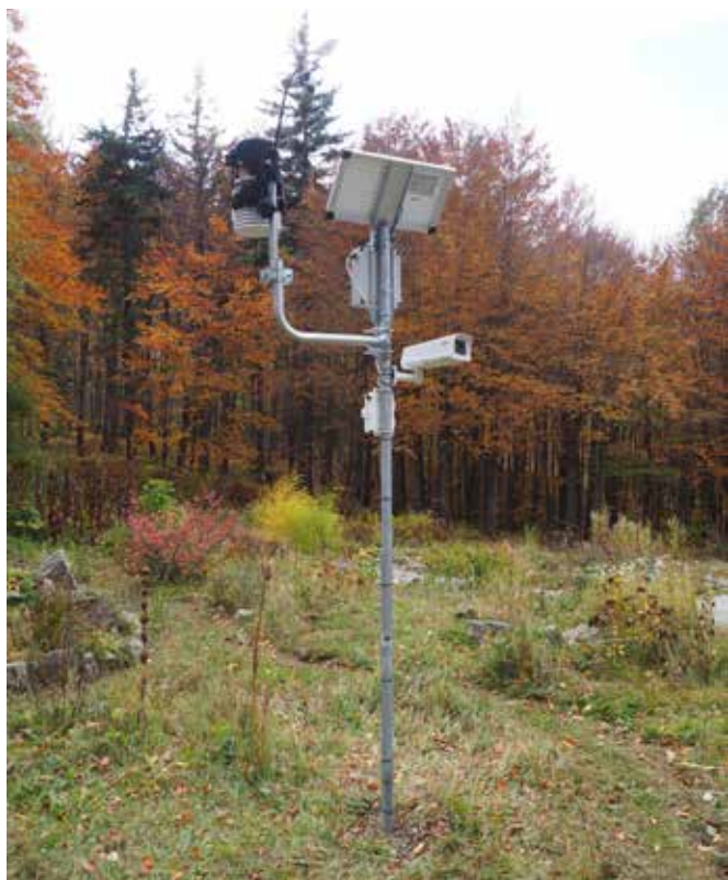
Fig. 20 - Centralina meteo presso il Rifugio Giardino Botanico Esperia, inserito all'interno del progetto "Rifugi Sentinella del Clima e dell'Ambiente" del del CAI - CNR (ph G. Margheritini)
