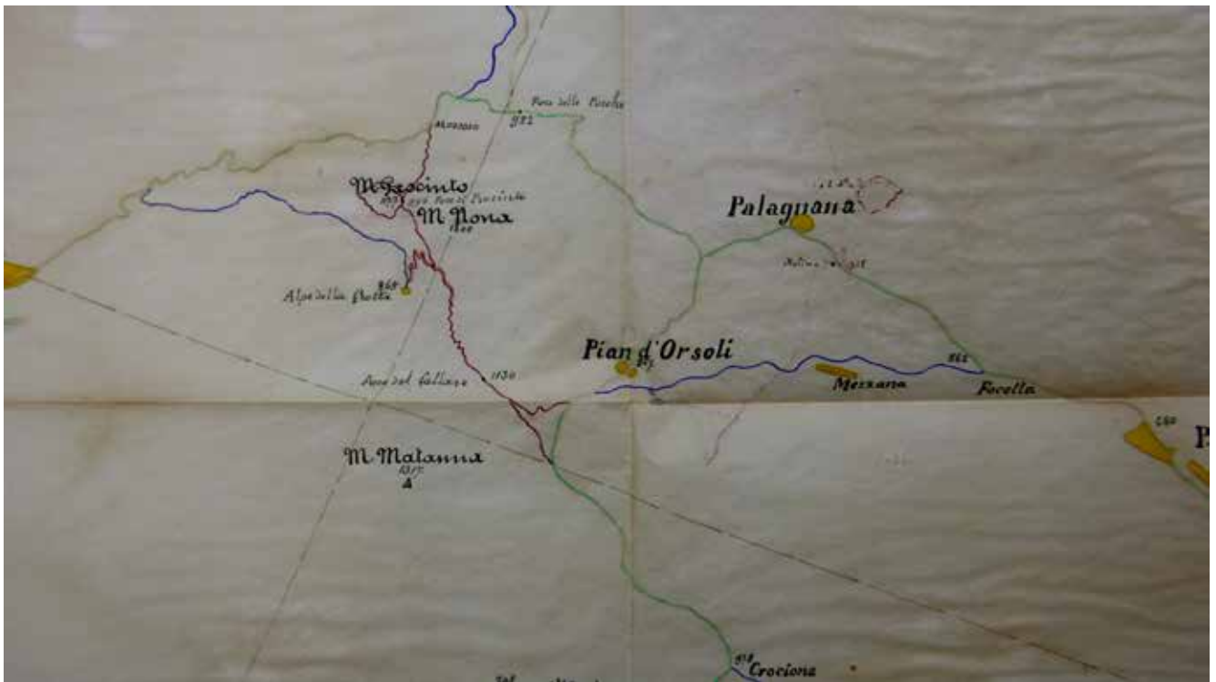
Stralcio della planimetria di progetto redatta dall'Ing. Aristide Bruni (1892 circa) per la realizzazione della nuova viabilità per il Calcare del Matanna e Foce di Procinto. In verde le mulattiere in esercizio, in blu le mulattiere esistenti che si integrano con la nuova viabilità di progetto. In rosso il nuovo percorso progettato e in costruzione - fonte: archivio Storico Sezione CAI Firenze
