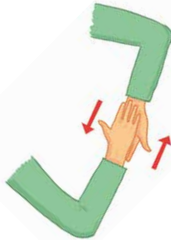
[Figura 68] - Se siete in difficoltà nel capire se siete di fronte a una faglia normale o inversa, provate a mettere le mani una sopra l'altra come in figura, inclinandole secondo la direzione della faglia. Ricordatevi, la mano che poggia sul dorso dell'altra è quella a tetto e deve avere le dita orientate verso l'alto perché il nostro gioco funzioni. Se, quando fate scivolare le mani l'una sull'altra, i gomiti - nostri ipotetici sforzi/stress - si avvicinano, state simulando una faglia inversa, altrimenti state mimando un movimento normale. Provare per credere – disegno Marco Viale
