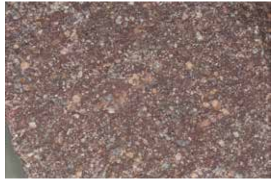
[Figura 135] - Il porfido, si vede chiaramente come i fenocristalli siano immersi in una pasta di fondo di colore rosso – ph Michele Pregliasco
