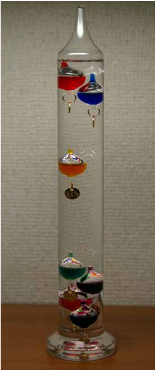
[Figura 81] - Un termometro galileiano, le piccole sfere al suo interno salgono e scendono a seconda della densità del liquido contenuto al loro interno che cambia in funzione della temperatura - da wikipedia
