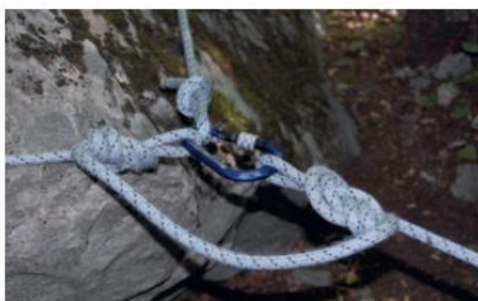
Ancoraggio su un grosso sasso direttamente con la corda di cordata tramite anelli costruiti con il nodo delle guide.
