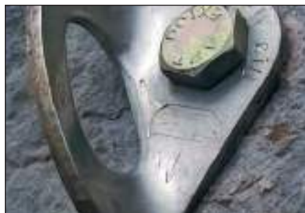
Fig.3 - Spit dall'esterno - è evidente la testa esagonale del bullone
