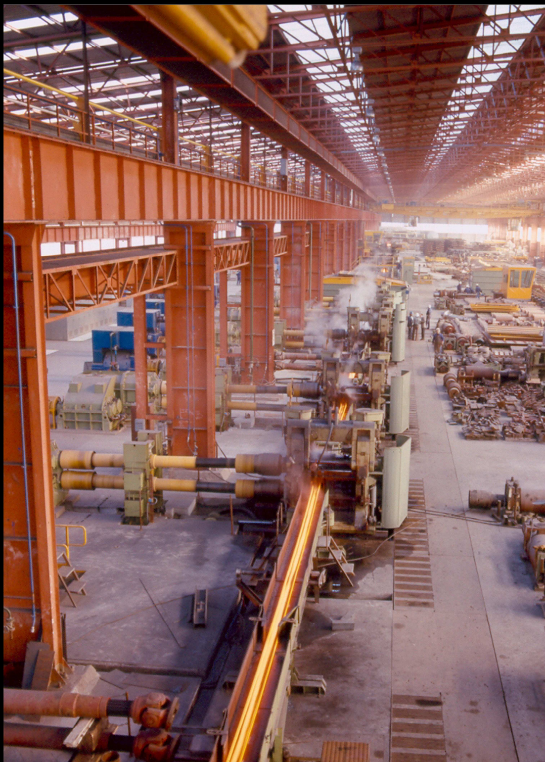
Treno in continuo di laminazione - Gabbie universali di laminazione
