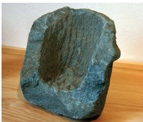
Lavorazione a scalpello (ben visibili le tracce dello scalpello)
